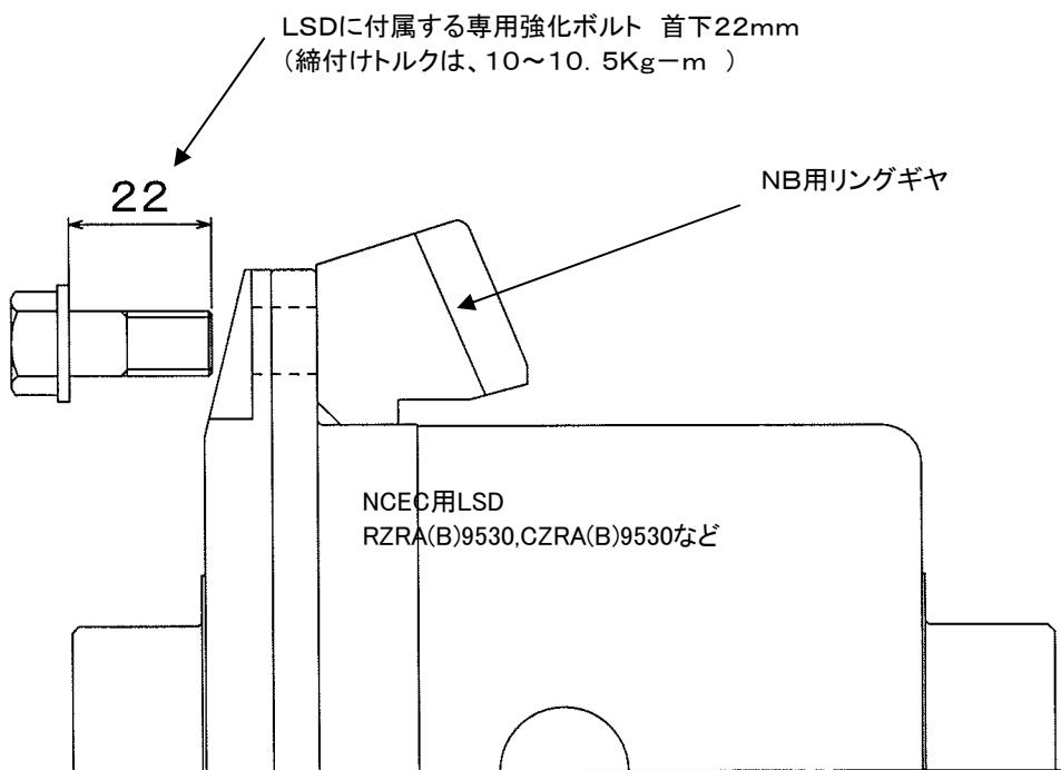
ご注意：専用強化ボルトの締付けトルクは、マツダ純正ボルトの締付けトルクとは異なります。
