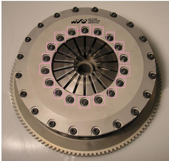
サラバネ（ダイアフラム）固定ボルトとナットの締め付けトルクは1.4kg-mです。
