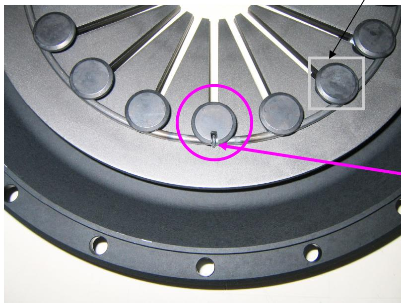
サラバネ固定ボルトの頭が写真の様なスリット加工がされているタイプの場合は、リングの突起部分をそこに合わせて固定して下さい。
